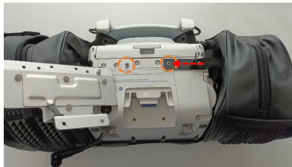
Rückhalteplatte positionieren und Stromstecker einstecken.
